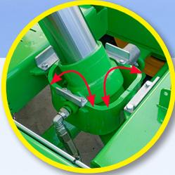
Teleskopischer Kippzylinder mit doppelter Oszillation, der in einer vorgeschobenen Position im Rahmen platziert ist
