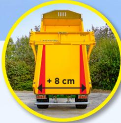
Fließende Entleerung dank eines konischen Kastens aus HARDOX 450
