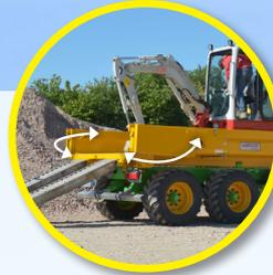
2 Möglichkeiten zur Öffnung der Heckklappe, um allen Ihren Bedürfnissen gerecht zu werden: manuelle Öffnung der beiden Seitenflügel oder hydraulische Öffnung der großen Heckklappe
